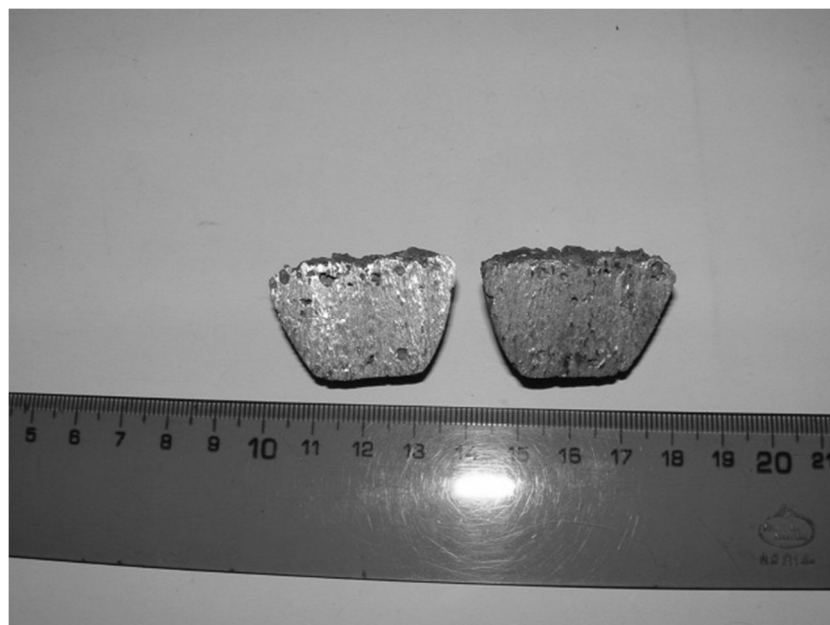
Figura 3.8: Aleación moldeada en coquilla
