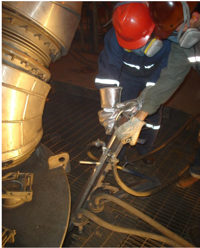
Figura A6.2: Lanza refrigerada sobre el atril en posición de captura de muestra
