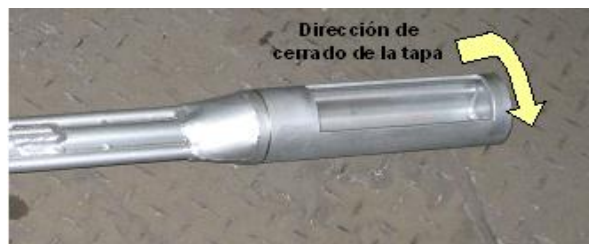
Figura 5.5: Detalle del toma-muestra de la lanza refrigerada
