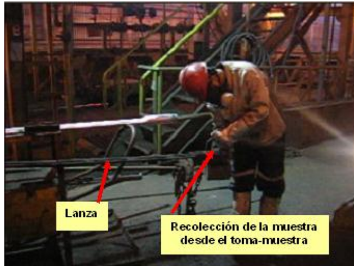
Figura A6.4: Obtención de la muestra de fundido desde la lanza refrigerada
